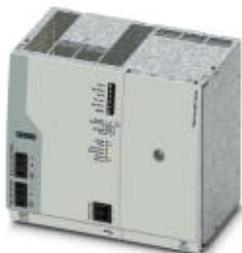
Источник бесперебойного питания 1AC/1AC/750 VA со встроенным энергоаккумулятором, свинцово-кислотный, технология VRLA, 24 DC, 3,4 А-ч для систем 230 В перем. тока.
