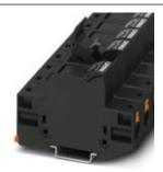
Клеммы для установки предохранителей, тип подключения: Зажимы Push-in, сечение: 1,5 мм²- 10 мм², AWG: 16 - 6, номинальный ток: 20 A, номинальное напряжение: 1000 B, ширина: 17,6 мм, тип предохранителей: Миниатюрный / 10,3 x 38, тип монтажа: NS 35/7,5, NS 35/15, цвет: черный
