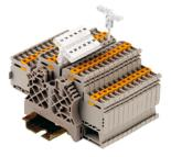
Держатель этикеток SnapMark разработан специально для двухуровневых клемм IDK 1.5N серии I. Гибкий поворотный механизм обеспечивает удобство установки и извлечения перемычек. Возможность прикрепления четырех маркировочных этикеток DEK 5 или двух маркировочных элементов для разъемов WS 10/5 Middle.
