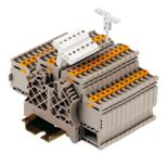
Держатель этикеток SnapMark разработан специально для двухуровневых клемм IDK 1.5N серии І. Гибкий поворотный механизм обеспечивает удобство установки и извлечения перемычек. Возможность прикрепления четырех маркировочных этикеток DEK 5 или двух маркировочных элементов для разъемов WS 10/5 Middle.
