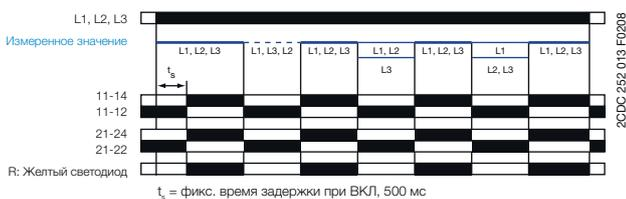
При наличии всех трех фаз и корректном чередовании фаз выходное реле активируется (контакт замкнут) после истечения времени выдержки при включении  $t_s$ . Если произошел обрыв фазы или нарушается последовательность чередования фаз, выходное реле немедленно обесточивается (контакт разомкнут). Когда реле активировано светится желтый светодиод (СИД).
