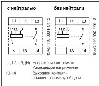
Схема подключения CM-PVS.x1
