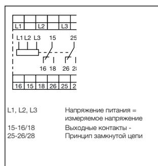
Схема подключения CM-PAS.x1
