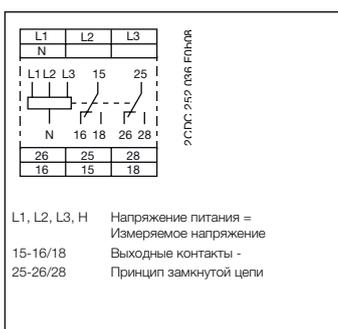
Схема подключения CM-MPN.x2
