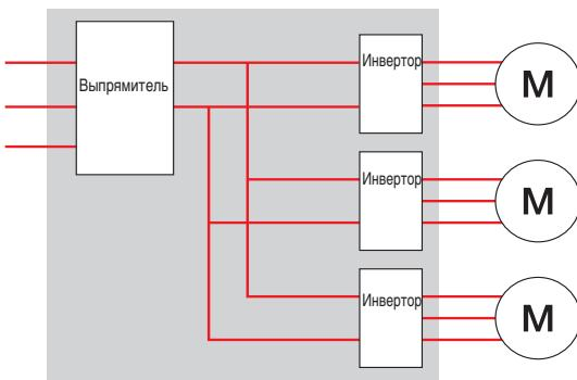
Конструкция привода мультидрайв позволяет упростить приводную систему в целом и обеспечивает много преимуществ, в числе которых:
