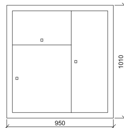
Щит этажный с автоматическим выключателем дифференциального тока (селективным) 63 А на вводе
