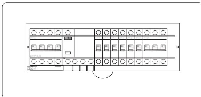
Щит квартирный с двухполюсным АВДТ со встроенной защитой от сверхтоков 40 А на вводе
