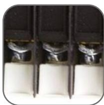
Тарельчатые зажимы обеспечивают надежное крепление проводника
