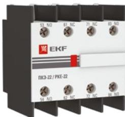
Приставки контактные предназначены для увеличения количества вспомогательных контактов контакторов КМЭ EKF PROxima и КТЭ EKF PROxima. На каждый из контакторов можно установить двух- или четырехконтактную приставку с различным набором размыкающих и замыкающих контактов. Контактные приставки механически соединяются с контакторами и фиксируются при помощи защелки.
