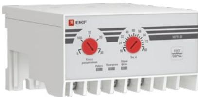
Реле защиты двигателя серии MPR предназначено для непрерывного контроля и защиты трехфазных асинхронных электродвигателей с короткозамкнутым ротором от перегрузки, асимметрии нагрузки, обрыва фазы.
