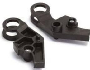
Устройство блокировочное предназначено для механического исключения одновременного отключения контакторов КТЭ на общей платформе в реверсивных схемах и схемах АВР. Одновременно с механической блокировкой может устанавливаться электрическая блокировка. Устройство блокировочное устанавливается сбоку контактора КТЭ, между двумя контакторами.
