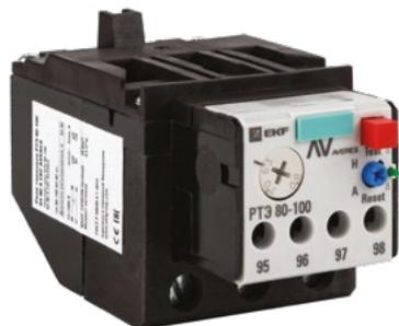
Тепловые реле серии РТЭ EKF AVRES предназначены для защиты трехфазных асинхронных электродвигателей с короткозамкнутым ротором от токовых перегрузок недопустимой продолжительности, в том числе возникающих при выпадении одной из фаз. Реле РТЭ AVERES применяются в качестве комплектующих изделий в схемах управления электроприводами совместно с контакторами серии КМЭ EKF AVERES. Все РТЭ EKF AVERES соответствуют классу 10А.
