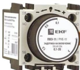
Позволяют получить задержку замыкания или размыкания вспомогательной цепи от 0,1 до 180 с. Приставка имеет один нормально разомкнутый (NO) и один нормально замкнутый (NC) контакт. Контактная приставка механически соединяется с контакторами и фиксируется при помощи защелки. Способ крепления обеспечивает жесткую и надежную связь между контактной приставкой и контактором.
