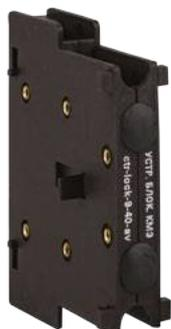
Блокировочные устройства предназначены для исключения одновременного включения контакторов на общей платформе в реверсивных схемах и схемах АВР. Одновременно с механической блокировкой может осуществляться электрическая блокировка. Блокировочное устройство устанавливается сбоку контактора, между двумя контакторами.
