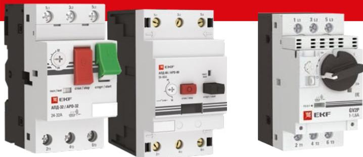
Автоматические выключатели пуска двигателя серии GV2P EKF PROxima, АД-32 EKF PROxima и АД-80 EKF PROxima с термомангнитным расцепителем специально предназначены для коммутаций цепей переменного тока напряжением до 690 В частотой 50/60 Гц, а также для управления и защиты трехфазных асинхронных двигателей от перегрузки, обрыва фазы, короткого замыкания.
