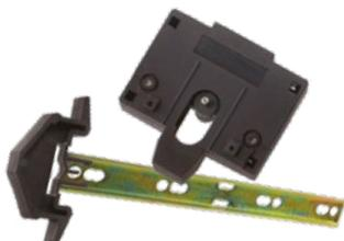
Блокировочные устройства предназначены для исключения одновременного включения контакторов на общей платформе в реверсивных схемах и схемах АВР. Одновременно с механической блокировкой может осуществляться электрическая блокировка. Блокировочное устройство устанавливается сбоку контактора, между двумя контакторами.
