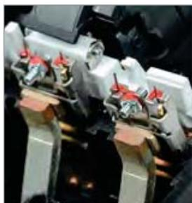
Новый конструктив термомангнитного расцепителя (катушка) на автоматах малых токов обеспечивает срабатывание термомангнитного расцепителя при  $10 I_n$ .
