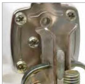
Контакты плавкой вставки выполнены в форме ножа (заострены), что позволяет их устанавливать в держателе с меньшими усилиями.
