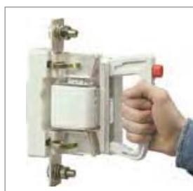
Все габариты плавких вставок ПНИ удобно устанавливать или демонтировать универсальной рукояткой съема РС-1, изоляция которой выдерживает напряжение до 1000 В.
