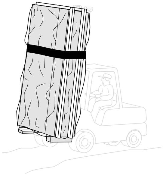
Шкафы рекомендуется транспортировать на палетах. Окончательную распаковку следует производить на месте установки изделия на объекте. Габаритные размеры и вес изделия отражаются на упаковке.
