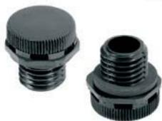
Компенсатор перепада давления DAE рекомендуется для обеспечения оптимальной вентиляции корпуса, а также для предотвращения образования конденсата - при этом сохраняется высокая степень защиты IP 69k. Мембрана обладает водо- и маслоотталкивающими свойствами.
