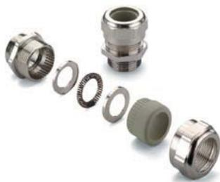
Латунный кабельный ввод для экранированного кабеля обеспечивает защиту от высокочастотных помех (затухание до 100 дБ). Контакт с экраном кабеля обеспечивается при помощи кольцевой пружины.
