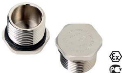
Заглушки предназначены для закрытия неиспользуемых резьбовых отверстий и обеспечения степени защиты IP, специально для применения во взрывоопасных зонах Ex, где требуется оборудование с маркировкой Ex e и Ex d.
