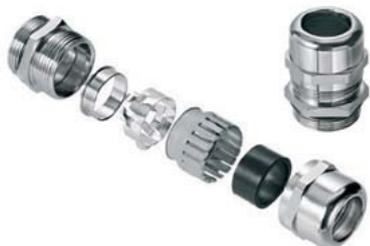
Латунный кабельный ввод для экранированного кабеля обеспечивает защиту от высокочастотных помех (затухание до 90 дБ). Большая поверхность контакта с экраном кабеля обеспечивается благодаря металлическому каркасу конической формы.
