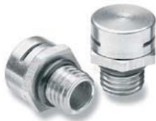
Компенсатор перепада давления DAE рекомендуется для обеспечения оптимальной вентиляции корпуса, а также для предотвращения образования конденсата - при этом сохраняется высокая степень защиты IP 69k. Мембрана обладает водо- и маслоотталкивающими свойствами.
