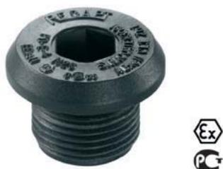
Заглушка с внутренним шестигранником - из нейлона, армированного стекловолокном. Применяется для закрытия неиспользуемых резьбовых отверстий, рекомендуется также для использования во взрывоопасных зонах Ex.
