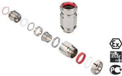
Универсальный кабельный ввод для кабелей и проводов с броней из несплетенной проволоки, металлической фольги, а также с оплеткой. Возможно также присоединение небронированного кабеля и проводов.
