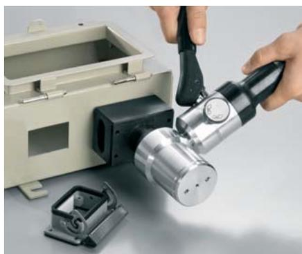
Автоматическая разметка в месте, где предусмотрено отверстие при помощи клеймения под промышленные разъемы.
